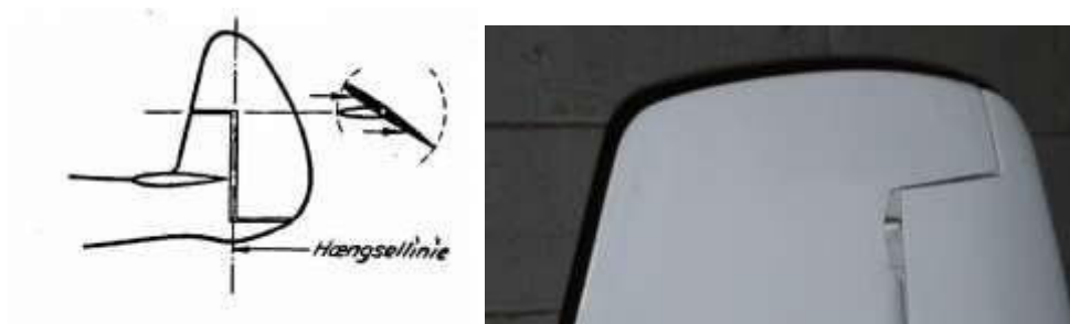
Aerodynamisk afbalancering på sideror
